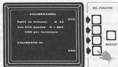
Fig.28 Linearizzato il Tuner TV nelle tre bande, staccate il Generatore di Rumore e pigiate per 2 VOLTE il pulsante in basso con la scritta END. Se lo pigiamo 1 sola volta riappariranno le scritte di fig.24.
