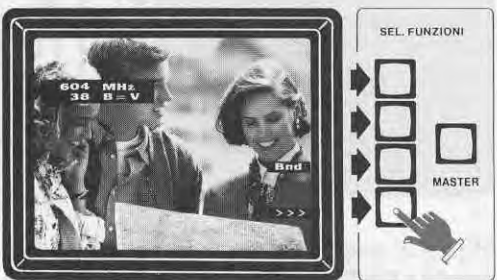
Fig.33 Pigiando Bnd ci sintonizzeremo sulle altre Bande. Pigiando il tasto >>> apparirà la barra del Vu-Meter ( vedi fig.34 ).
