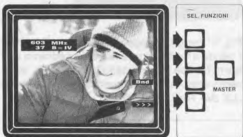
Fig.32 Ruotando la manopola della sintonia appariranno le immagini delle altre emittenti con la frequenza, il Canale e la Banda.
