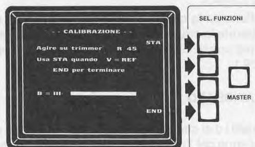
Fig.26 Memorizzata la Banda 1° sullo schermo apparirà automaticamente la scritta B = III ( banda 3° ) e nuovamente vedremo apparire una barra bianca che memorizzerà nella RAM la linearità del Tuner.
